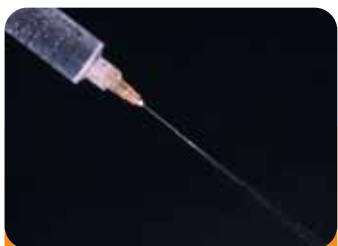
10.a. Handspuit 10 ml met een zogenaamde Luer-Lock-systeem om het losraken van de naald (27-30 gauge) te voorkomen. Zorg er tevens voor dat er zich geen luchtballen in de spuit bevinden om nadruppelen te voorkomen. Het gevaar voor morsen op kleding wordt zo verkleind.
